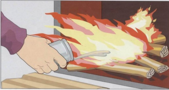
Применение для розжига печей легковоспламеняющихся и горючих жидкостей, выпадение угля, трещины в кладке, возгорание сажи в дымоходах
